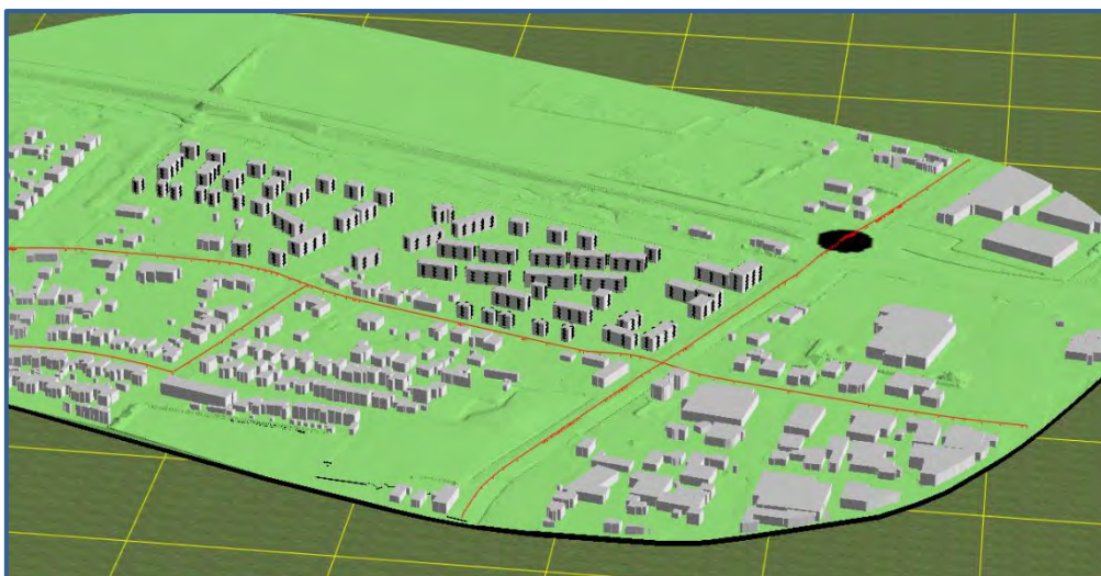
Afbeelding 4. Rekenmodel wegverkeerslawaaï omgevingswet, 3d-weergave
